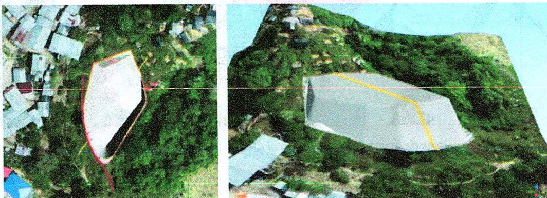
Figura 27. Detalle de cálculo volumétrico del Área 2, Alternativa 2, Deposito de Relaves deshidratados y compactados, con excavación hasta la cota 1065. Fuente Geominas, 2024.
